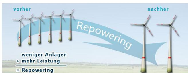
*Repowering bedeutet eine Halbierung der Anlagenzahl, Verdopplung der Leistung, dreifacher Stromertrag, Hälfte der Umdrehungszahl, Steigerung der Vollaststunden, deutlich verbesserte Netzverträglichkeit moderner Anlagen<sup>54</sup>.*
