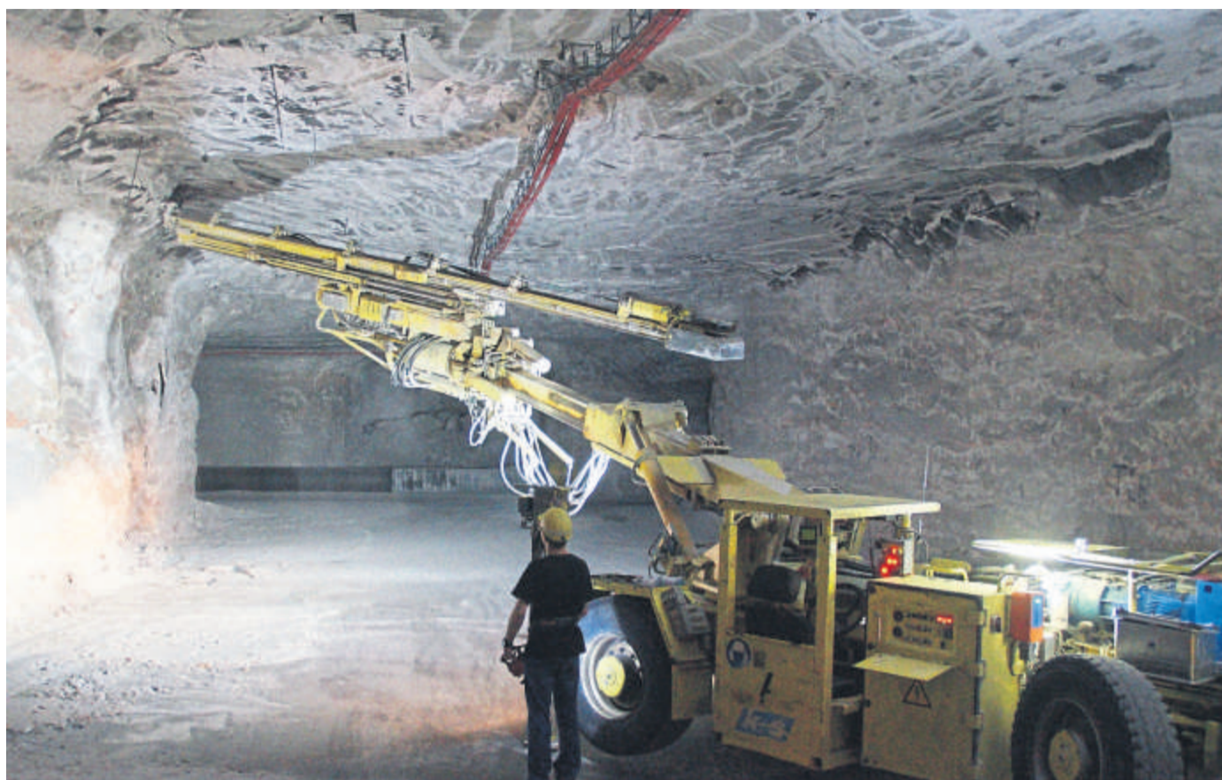
Schweres Gerät unter Tage: Ein Sprenglochbohrwagen bei der Arbeit in der Grube von K+S in Unterbreizbach.
