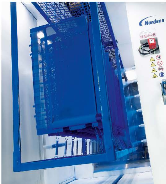
Zu den Kennzeichen der eingesetzten Dichtstromtechnologie zählen eine sehr weiche Pulverwolke sowie eine sehr gute Deckung bei Vertiefungen. Sie ermöglichen die hochwertige Beschichtung der Lochbleche.
