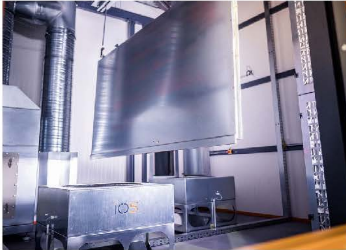
In der Kühlzone, hier während der Einstellung der Anlage, kühlen die Werkstücke binnen 15 min von 200 °C auf Raumtemperatur ab.
