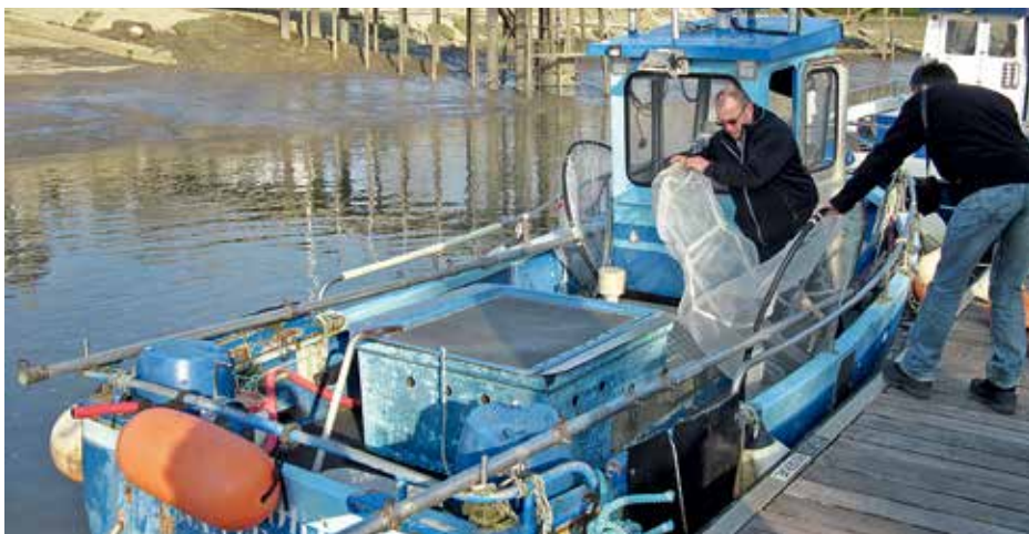
Abb. 1: Kutter für den Glasaalfang mit Hälterkasten in der Mitte und den beiden Fangkeschern für die Glasaale an den Seiten
