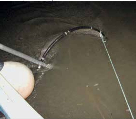
Abb. 2: Schleppnetz mit Haltestange beim Heben am Ende einer Schleppstrecke
