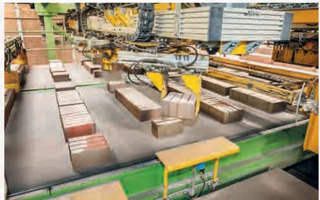
Das gebrannte Material und somit der fertige Bockhorner Klinker wird entladen. Nach der Qualitätskontrolle im Werk und Labor gehen die Klinker schließlich in den Verkauf.
