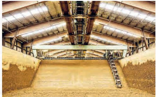
Kostbares Gut: Der abgebaute Lehm wird im sogenannten Sumpfhaus aufbereitet, ehe er gepresst und im nächsten Schritt in Klinkerform gebracht wird.
