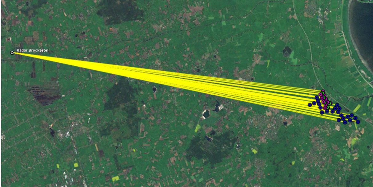
Abbildung 2: Luftaufnahme des Windparks Hiddels mit den geplanten Windenergieanlagen (grün), dem Rückbau (magenta) sowie der Vorbelastung (blau). Die Einstrahlungsrichtungen bzgl. der Radaranlage Brockzetel sind gelb dargestellt.
