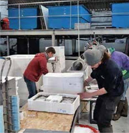
6. Ein Paket aus fünf Kisten wird verschlossen und für die Sauerstoffüberschichtung vorbereitet
