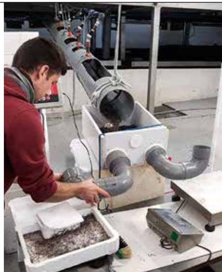
2. Aus dem Verteilbecken werden die Ao in die Transportkisten geleitet und eingewogen
