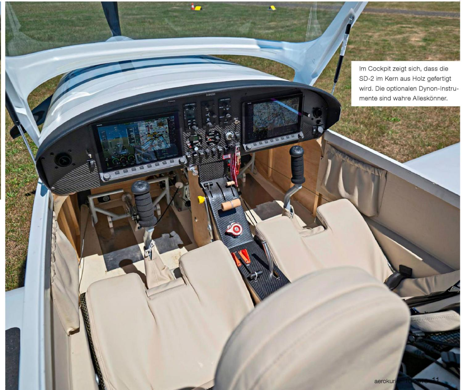
Im Cockpit zeigt sich, dass die SD-2 im Kern aus Holz gefertigt wird. Die optionalen Dynon-Instrumente sind wahre Alleskönner.
