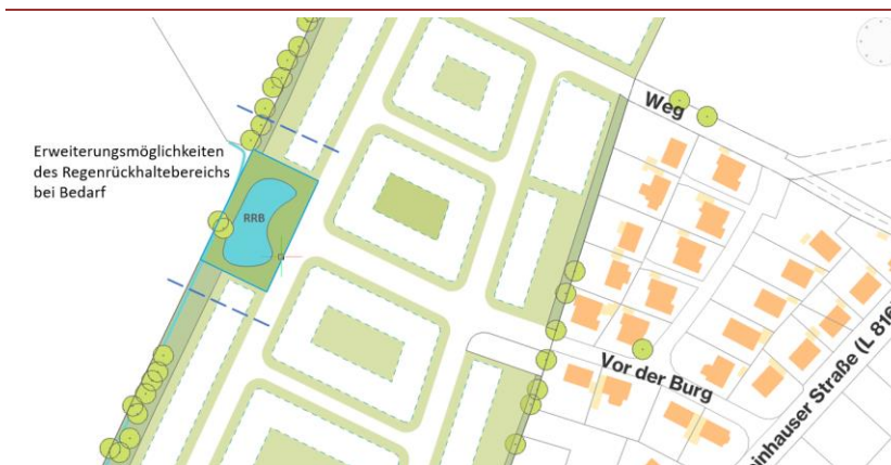
Abb. 20 Lage des geplanten Rückhaltebereiches
