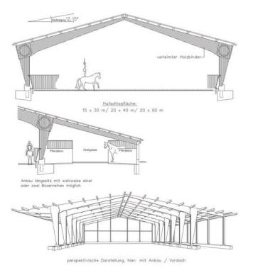
Dacheindeckung mit asbestfreien Faserzementplatten, auf Holzkoppelpfettenlage. Alternativ mit Sandwichelementen oder Trapezblechen mit Vlies. Alle Dacheindeckungen sind in diversen Farben möglich. Eine feuerhemmende Ausführung in F30-B nach DIN 41 02 ist mit geringem Aufwand realisierbar.
