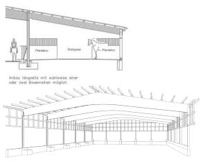
Dacheindeckung mit asbestfreien Faserzementplatten, auf Holzkoppelpfettenlage. Alternativ mit Sandwichelementen oder Trapezblechen mit Vlies. Alle Dacheindeckungen sind in diversen Farben möglich.
