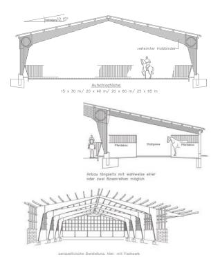
Dacheindeckung mit asbestfreien Faserzementplatten, auf Holzkoppelpfettenlage. Alternativ mit Sandwichelementen oder Trapezblechen mit Vlies. Alle Dacheindeckungen sind in diversen Farben möglich. Eine feuerhemmende Ausführung in F30-B nach DIN 41 02 ist mit geringem Aufwand realisierbar.
