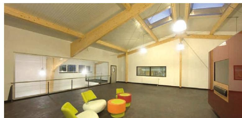
Dieser Hallentyp realisiert eine klare Lösung einer Produktionshalle o. ä. Mögliche Dacheindeckungen: asbestfreie Faserzementplatten, Sandwechelemente oder Trapezbleche mit Vlies. Alle Dacheindeckungen sind in diversen Farben möglich. Eine feuerhemmende Ausführung in F30-B nach DIN 41 02 ist mit geringem Aufwand realisierbar.
