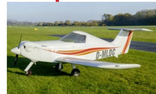
**Kleiner Bruder** Die einsitzige SD-1 teilt sich viele konstruktive Merkmale mit der SD-2, zum Beispiel den Flächenaufbau und das T-Leitwerk.
