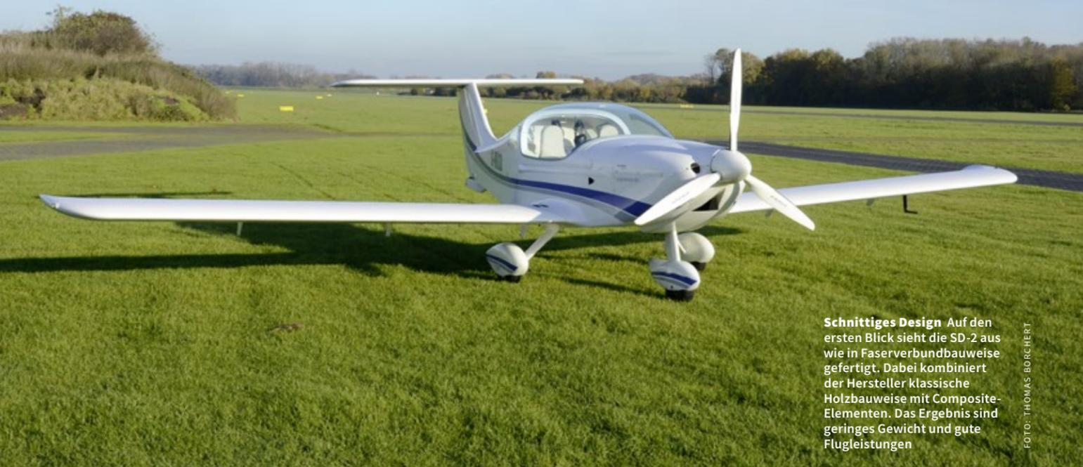
**Schnittiges Design** Auf den ersten Blick sieht die SD-2 aus wie in Faserverbundbauweise gefertigt. Dabei kombiniert der Hersteller klassische Holzbauweise mit Composite-Elementen. Das Ergebnis sind geringes Gewicht und gute Flugleistungen
